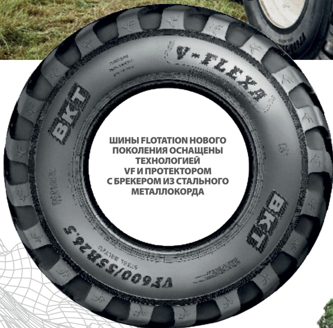
ШИНЫ FLOTATION НОВОГО ПОКОЛЕНИЯ ОСНАЩЕНЫ ТЕХНОЛОГИЕЙ VF И ПРОТЕКТОРОМ С БРЕКЕРОМ ИЗ СТАЛЬНОГО МЕТАЛЛОКОРДА
