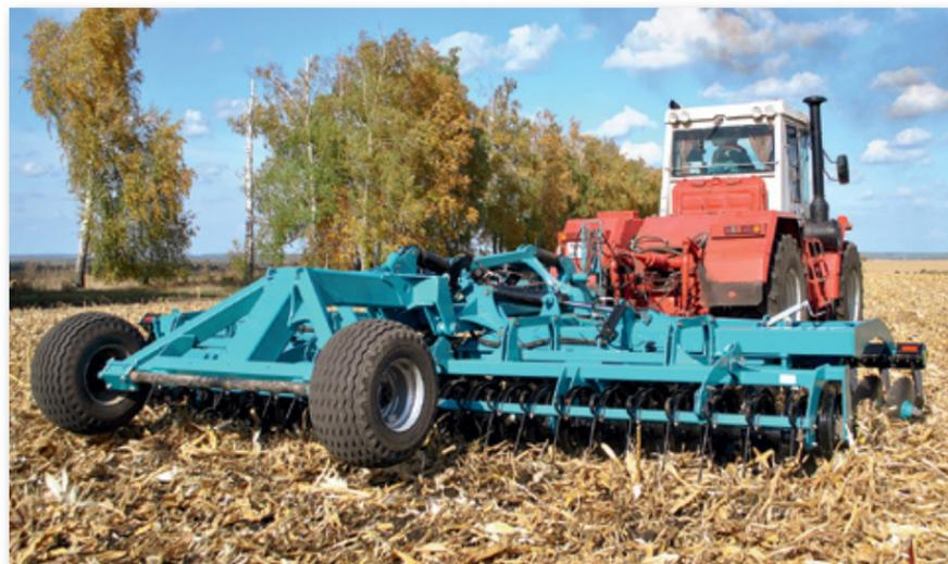
диаметром 510 мм и катки, а также механизмы регулировки глубины хода, шасси и гидросистема. В целом испытание показало, что при использовании машин массовая доля заделанных в почвенный слой пожнивных остатков удовлетворяла требованиям ТУ — не менее 60%. Крошение почвы по содержанию фракций размером до 25 мм также соответствовало установленным нормам — минимум 90%.
